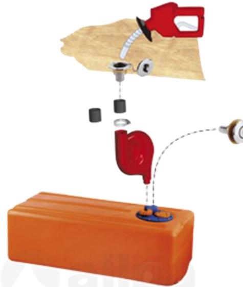
Dieser Anti-Schaum-Überlauf ist direkt an einen Deckeinfüllstutzen zu montieren. Überlaufender Treibstoff und die Schaumkrone werden aufgefangen und laufen wieder zurück in den Tank. Komplett mit 2 Gummi. Adaptern mit Klemme für 38 oder 50 mm Anschluss. Tankseitig gibt es 38 und 50 mm Schlauchanschlüsse. H = 350mm
