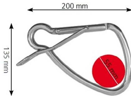
Bojen-Karabinerhaken aus Edelstahl 1.4401 der komplett ohne Befestigungen am Bootshaken auskommt. Durch seine enorme Öffnungsgröße und die einfache Handhabung wird das An- und Ablegen an einer Boje erheblich vereinfacht. Nach CE EN 795/B. Eine Sperrvorrichtung verhindert ein Öffnen durch Bewegungen und verdrehen.
